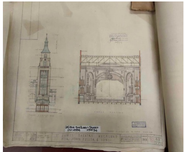
Figura 15. White, Henry E. (1927). Planos arquitetônicos para o St James Theatre Auckland para John Fuller and Sons, Seção longitudinal. Arquivos do Conselho de Auckland. Fotografado para referência por Billie Fee.
